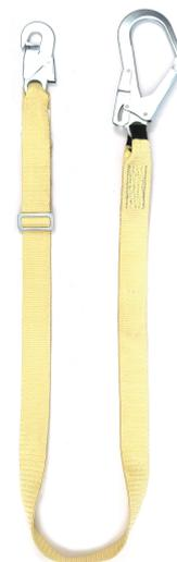
Строп удерживающий ленточный SLU-2F применяется для удержания работника от попадания в зону риска, где возможно падение с высоты. Также может использоваться в качестве стропа для позиционирования. Максимальная длина изделия - 2 м. Строп используется совместно с привязью для удержания и позиционирования или в страховочной системе, имеющей в своем составе амортизатор.
