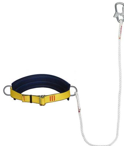
Удерживающая система УС 1В (УП I В) строп канат представляет собой безлямочную удерживающую систему (пояс). Изделие предназначено для выполнения функций удерживания и поддержания рабочего на определенной высоте. Состав: ремень, кушак, два элемента крепления для рабочего позиционирования, строп В (канат) с монтажным карабином. Удерживающая система не предназначена для использования с целью страховки при падении. Состав: ремень, кушак, два элемента крепления для рабочего позиционирования, строп.
