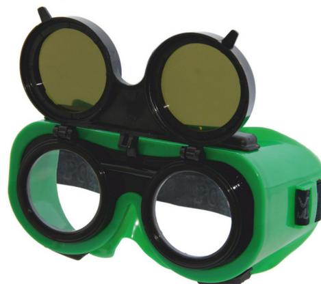
Очки с откидным блоком из термостойкой пластмассы с защитными минеральными стеклами и внутренними стеклами из бесцветного поликарбоната PC. Конструкция 2 в 1 позволяет вести работы: с опущенным стеклодержателем - связанные с опасным для глаз излучением, с поднятым стеклодержателем - связанные с защитой глаз от воздействия твердых частиц. Мягкий корпус из ПВХ. Защитное минеральное стекло-светофильтр тёмно-зелёного цвета для защиты от УФ и ИК-излучений при газовой сварке и резке средней мощности.
