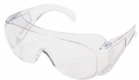
Универсальные очки с панорамным защитным стеклом увеличенного размера из бесцветного поликарбоната с твердым покрытием на наружной стороне и с незапотевающим покрытием на внутренней, обращенной к глазу, стороне.
