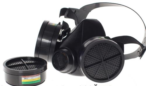
Респиратор обеспечивает защиту органов дыхания от вредных примесей при их концентрации до 10-15 норм ПДК. Так же респиратор оборудован клапаном выдоха и состоит из резиновой полумаски, оголовья, двух сменных поглощающих фильтров (марок А1, В1, Е1).
